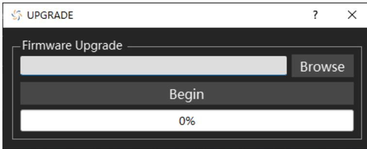
注：任何打断升级过程的操作都可能引起升级失败甚至仪器无法启动，请在升级过程中保持仪器的供电与稳定状态。
