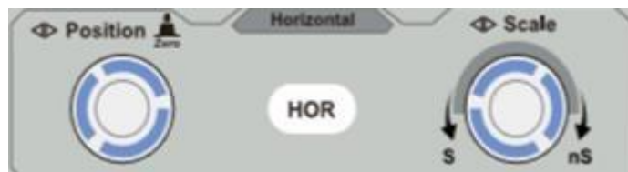
Figure 3-11 水平軸コントロール・エリア
