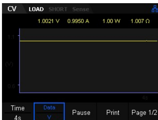
図 2-7 CV モードの波形表示インターフェース
