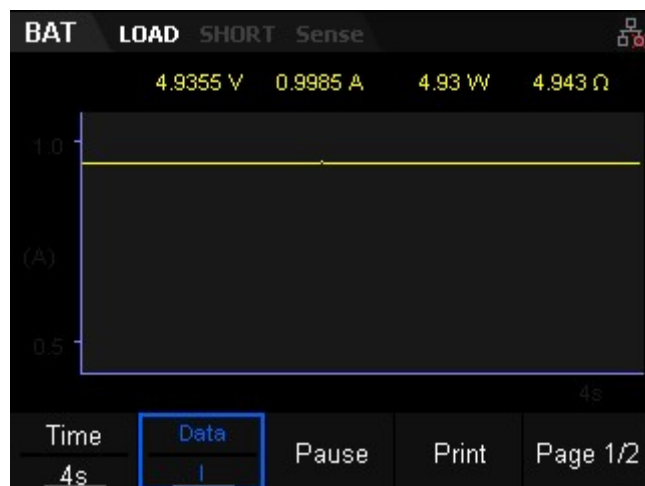
図 2-40 BAT の波形表示インターフェース
