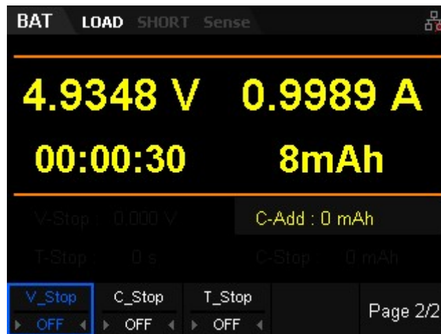
図2-39 バッテリーテスト機能ページ2
