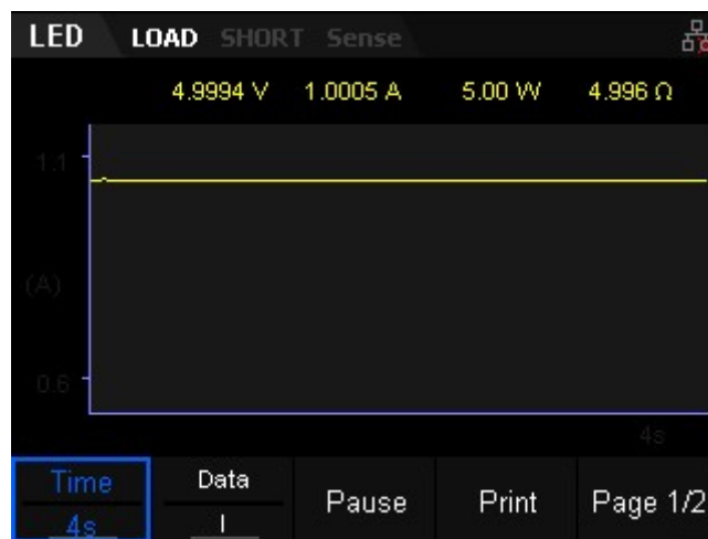
図 2-47 LED テストモードの波形表示インターフェース
