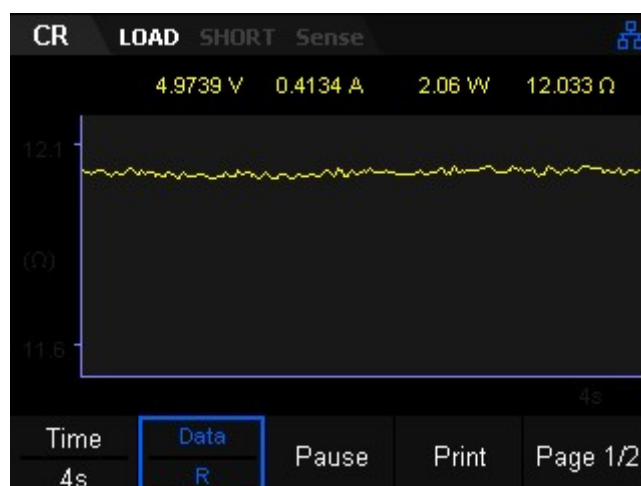
図 2-10 CR モードの波形表示インターフェース
