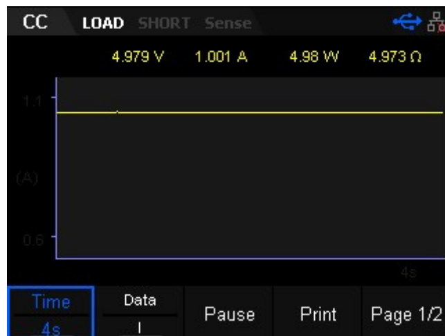
図 2-4 CC モードの波形表示インターフェース
