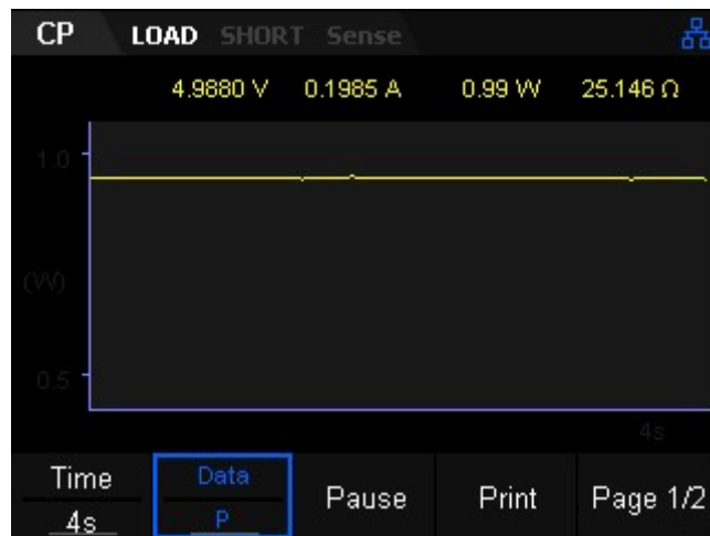
図2-13 CPモードの波形表示インターフェース
