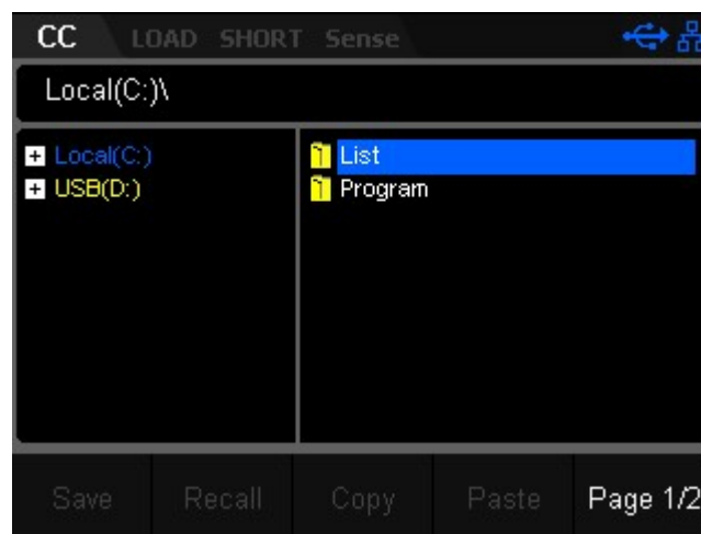
図2-49 CCモード時の保存・呼び出しインターフェース
