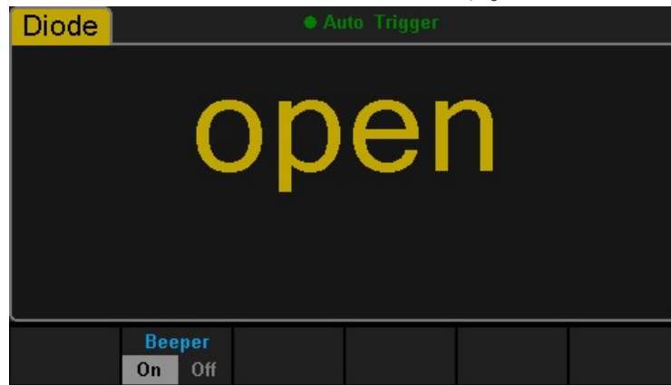
図 2-25 ダイオードテストインターフェース
