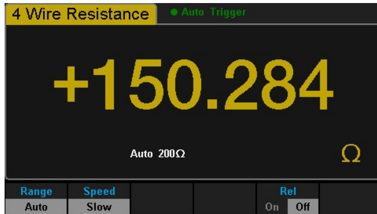
図 2-15 4 線式抵抗測定インターフェース
