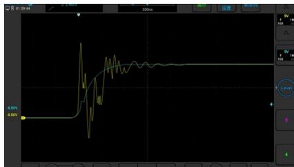
SiCやGaNのようなデバイスは、高エネルギーの高周波高調波を含む高電圧を数ナノ秒で切り替えることができます。SigOFITは最大帯域幅においても100dB以上のCMRRを有し、高周波コモンモードノイズによる発振を抑制します。
