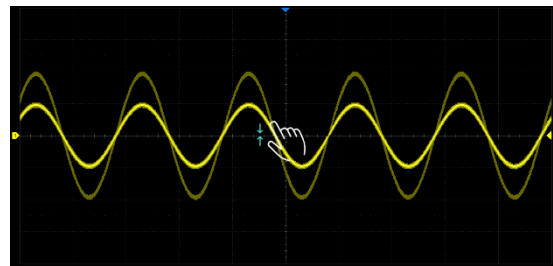
波形をピンチやスプレッドして垂直ゲインを再スケール
