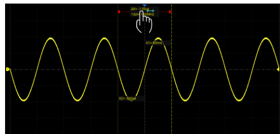
カーソル情報領域をタッチして、カーソルのペアを同時に移動
