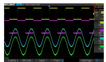
⑫フル・チャンネルの最高サンプルレートは500MSa/s (4チャンネルシリーズのみ)
