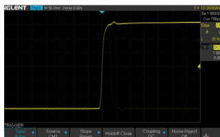
①最大波形更新レート100,000wfms/s
