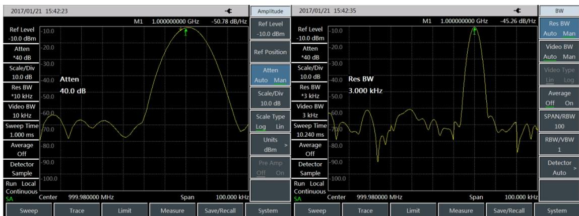
図4-11 ノイズマーカー機能によるノイズ測定
