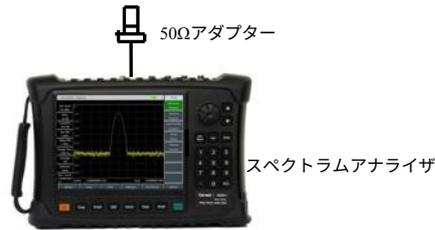
図12-14 残留応答試験の設定
