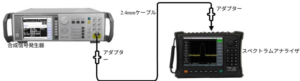
図4-1 信号発生器とスペクトラムアナライザの接続図
