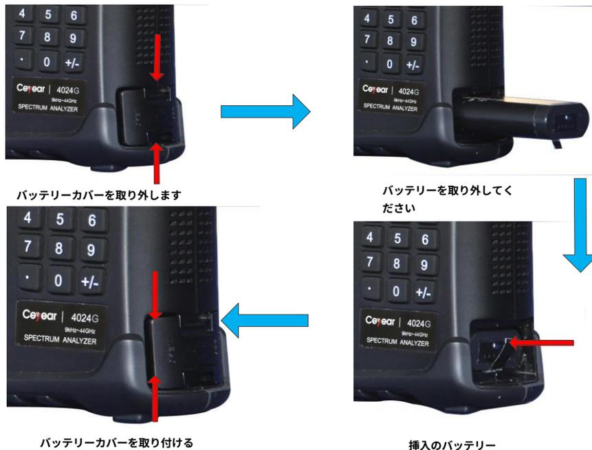
図2-1 バッテリーの取り付けと交換手順
