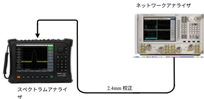
図12-18 入力ポートの電圧定在波比試験
