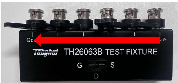
テスト・フィクスチャ(型式：TH26063B)をご用意してください。レバーの方向を左向けに調整してください。
