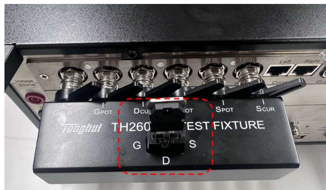
テスト・フィクスチャ(型式 : TH26063B)のG、D、S端子に赤枠内にMOSFETを挿入してください。
