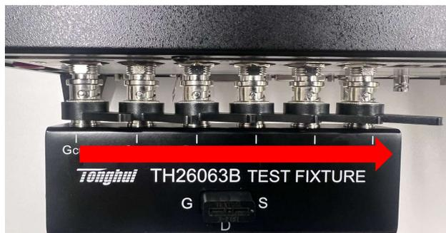
テスト・フィクスチャ(型式 : TH26063B)のレバーの方向を右向きにロックしてください。
