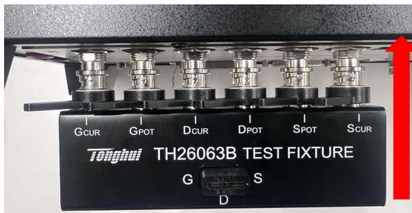
テスト・フィクスチャ(型式：TH26063B)をCH1かCH2の端子を挿入してください。
