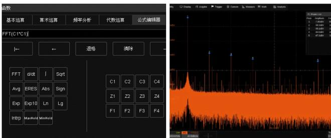
従来の(+、-、×、/)演算に加え、FFT、積分、微分、平方根などにも対応しています。より複雑な操作のためにフォーミュラエディターが利用可能です。ハードウェアアクセラレーションによるFFTは、最大2Mptsの演算をサポート。これにより、高速リフレッシュレートで高周波の分解能を実現します。さらに、FFT機能は様々なウィンドウ機能に対応しており、異なるスペクトル測定ニーズに対応することができます。
