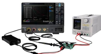
パワー解析オプションは、スイッチング電源やパワーデバイスの設計における測定効率を大幅に向上させる、パワー測定と解析機能です。
