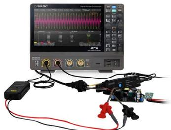
内蔵の波形発生器やスタンドアロンのSIGLENTジェネレータを制御して、DUTの振幅と位相の周波数特性をスキャンし、そのデータをボード線図として表示できます。
