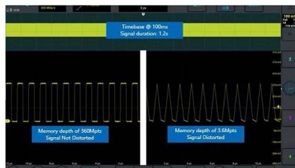
最大360Mptsのメモリにより優れた信号忠実度を実現。メモリを複数セグメントに分割し、複数のトリガーイベントを各セグメントにキャプチャして、後からプレイバック解析をすることもできます。
