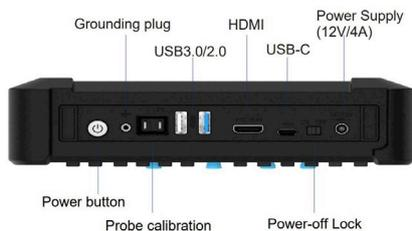
USB 3.0/2.0 ホスト、USB Type-C、アース、HDMI、トリガー出力インターフェースを標準装備しています。
