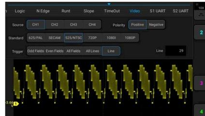
エッジ、パルス、ロジック、Nエッジ、ラント、スロープ、タイムアウト、ビデオおよびシリアル・トリガをサポートしています。
