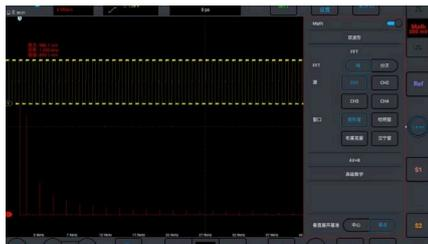
加算、減算、乗算、除算、積分、微分など高度な信号解析のためのカスタム関数式をサポート。また、収集した波形信号のリアルタイムスペクトル解析のためのFFTすることもできます。
