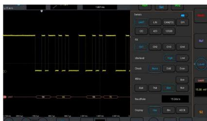
RS-232/422/485/uart、can、lin、can fd、spi、i2c、arinc-429、1553b シリアルバスデコードを標準装備。テキストデコードモードで、データをCSV形式に転送できます。
