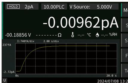
TH2690シリーズは0.01fA電流測定分解能と1000PΩの抵抗値測定で材料特性の研究やデバイスの性能判定における多様な測定ニーズに対応可能です。
