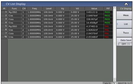
チャンネル、パラメータ、および測定条件の任意の組み合わせをサポートし、制限範囲を設定して測定結果を表示できます。
